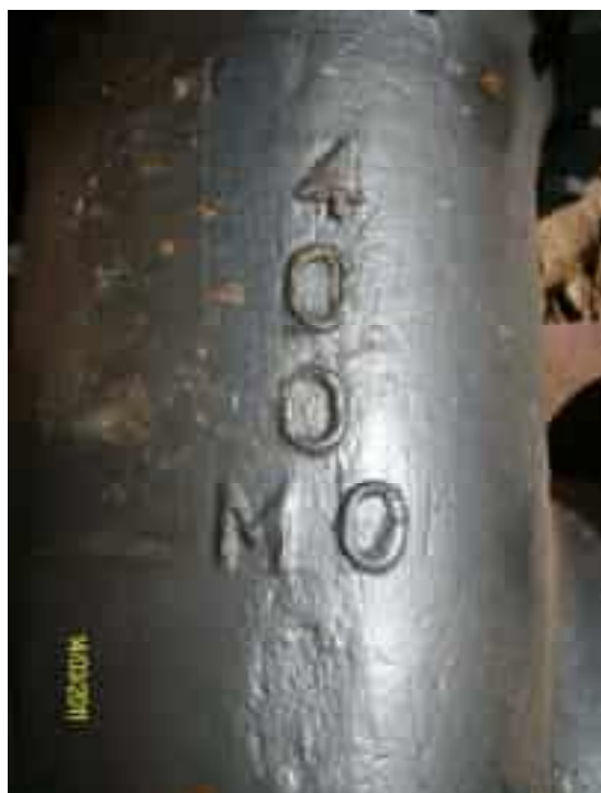
Registro de Gaveta: numeração 400 se refere ao diâmetro nominal DN 400 mm. Inscrição MO refere-se à série construtiva métrica oval. Acabamento regular
